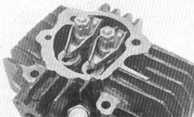
Afb. 52. — DEMONTAGE VAN DE KLEPTUIMELAARS.
