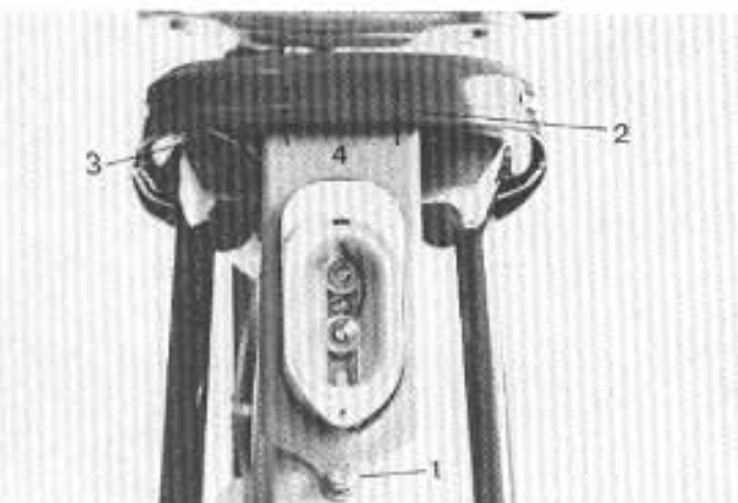
Afb. 33. — DEMONTAGE STEUNPLAAT ACHTERLICHT.
