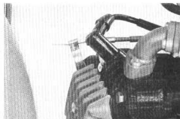
Afb. 47. — KLEPLICHTER HEVEL AFSTELLING.
