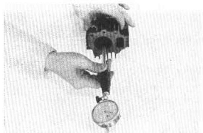
Afb. 65. — HET METEN VAN DE CILINDER BORING.
