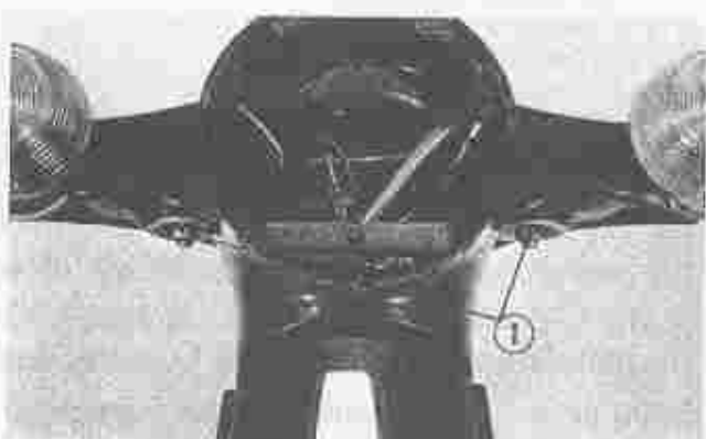
Fig. 89 Demonteren van stuur ① 8 mm bouten C50
