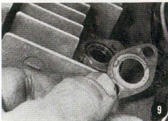
Der Vergaser wird nun in einen sauberen Lappen gewickelt (wenn nicht daran gearbeitet werden soll) und weggehängt, etwa mit Bindfaden an den Verschlussdeckel vom Kraftstofftank.
