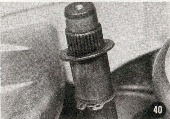
Das große Zahnrad mit dem Freilauf wird abgenommen, darunter finden wir eine Anlaufscheibe (Dicke 1,0 mm = bleibt immer die gleiche Scheibe), die das Zahnrad gegen den Seegerring abstützt. (Bild 40). Der Seegerring braucht nie abgenommen zu werden.
