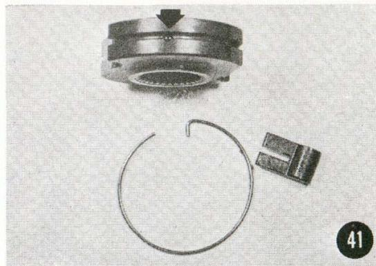
Die Kupplungsglocke (Ersatzteilbezeichnung: „Ritzel 12 Z, vollst.“) kann von Hand abgenommen werden. Auf ihrem inneren Zapfen sitzt ein kleines Nadellager, das aber auch in der Bohrung im Kupplungskörper steckenbleiben kann. Mit einem Drahthaken holt man das Lager und die darunterliegende dicke Druckscheibe heraus. (Bild 42).
