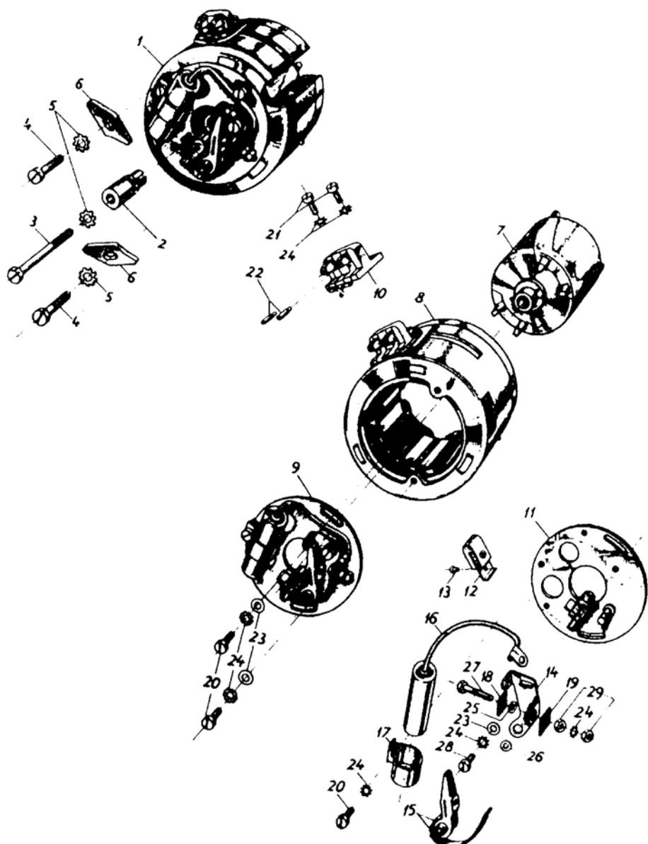
Magnetic dynamo generator with contact breaker - Magdynamo mit
