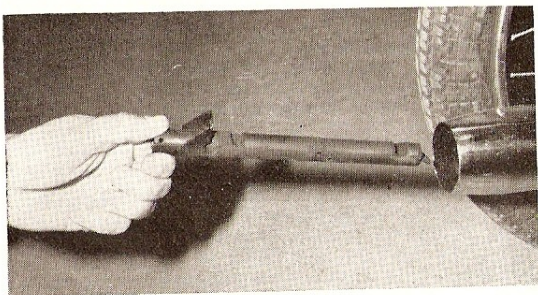
Dépose de la chicane d'échappement pour son décalaminage (Photo RMT)
