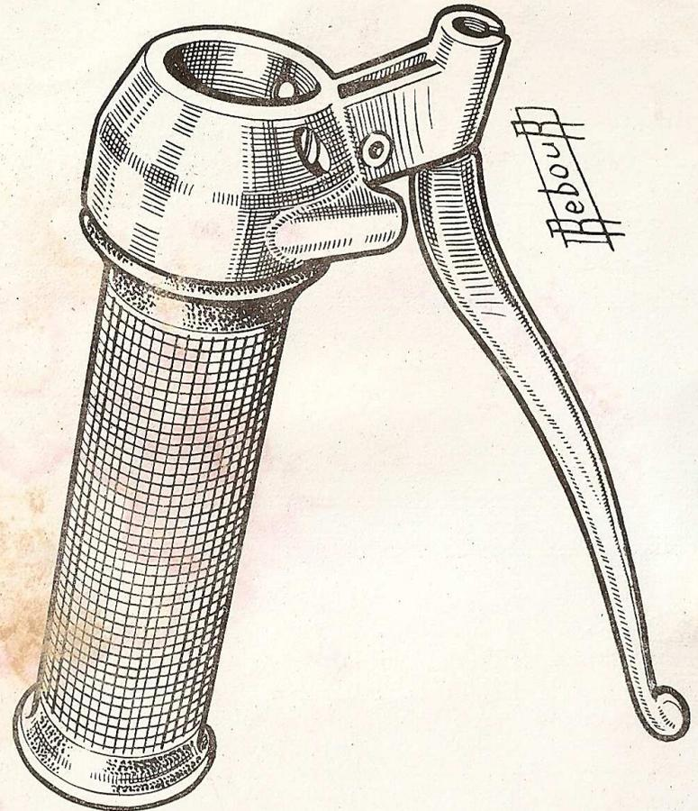
La poignée tournante est munie d'un levier de freins. Elle est conçue pour la manœuvre du changement de vitesse.
