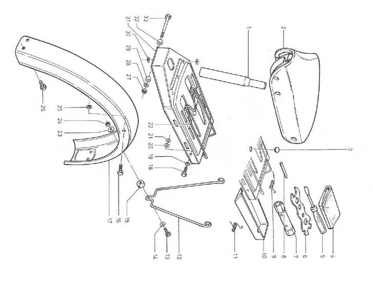
Gruppe: <u>Hauptrahmen/Sattel</u>, Werkzeugsatz, Werkzeugbehälter, Hinterrad-Kotflügel, Gepäckträger
