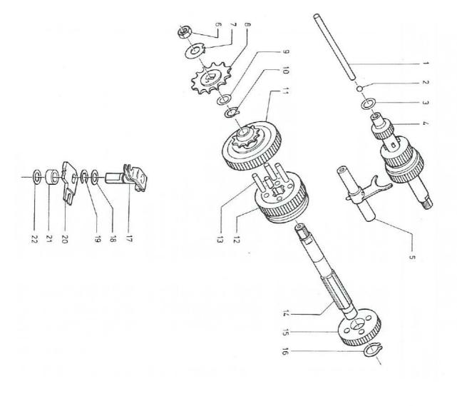
Gruppe: Movor/Schaltgetriebe, Schaltantrieb
