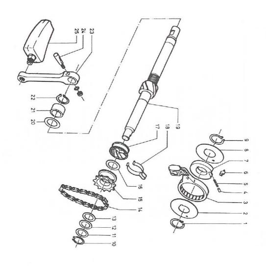
Gruppe: Motor/Bremsgesperre, Tretwelle, Kurbel, Pedale Hinterrad-Bremszug, Bremslichtschalter
