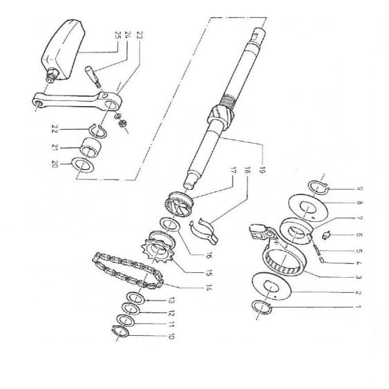
Gruppe: Motor/Bremsgesperre, Trotwelle, Kurbel, Pedale, "interrad-Bremszug
