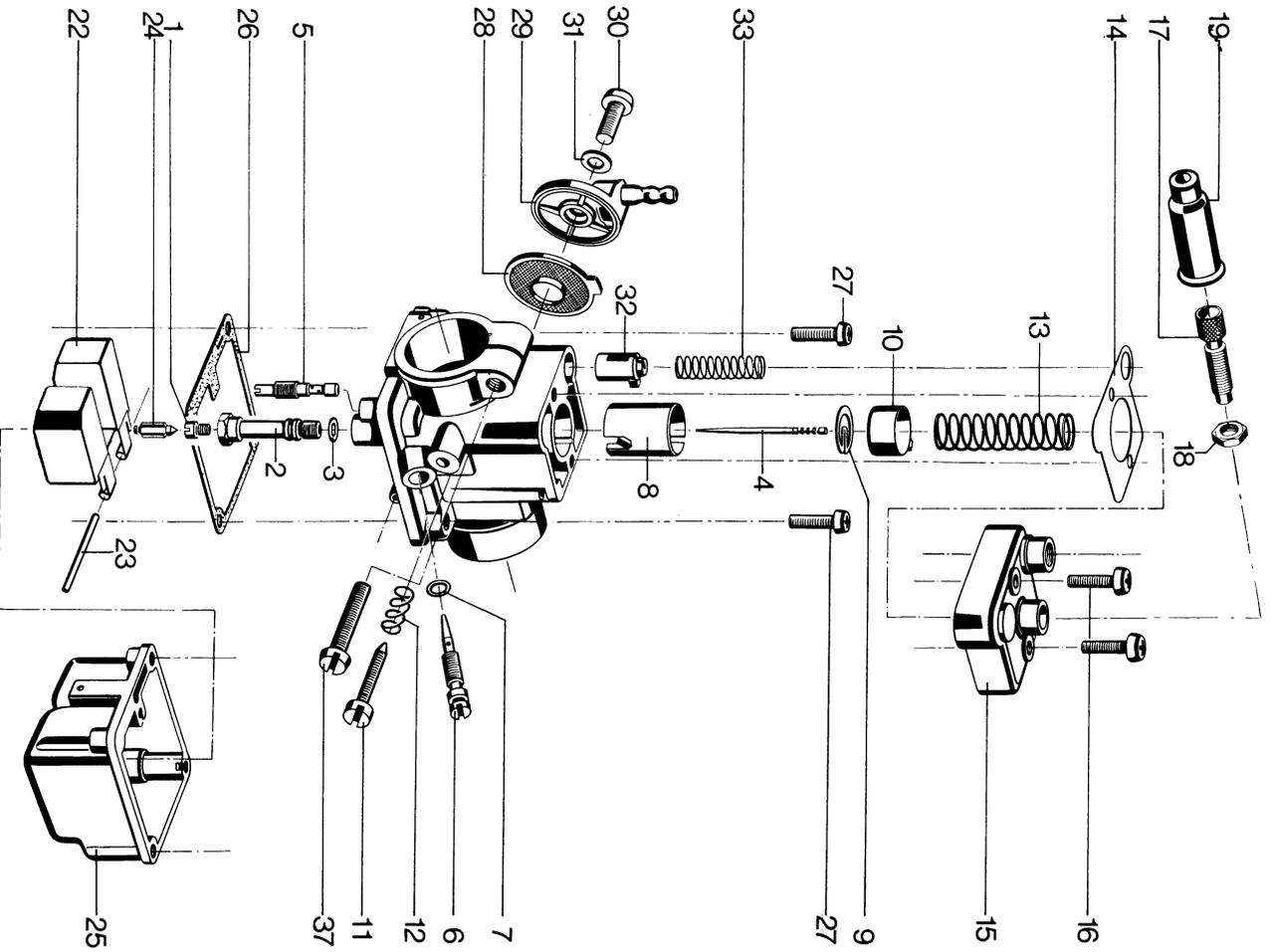
**Bild-Nr.** 24/25 **Benennung** Vergaser, vollst. BING
